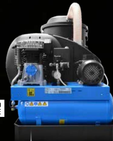
LE SYSTÈME SP PERMET DE DÉCOLMATER AUTOMATIQUÉMENT SANS ARRÊTER L'ASPIRATION. CHAQUE FILTRE EST PÉRIODIQUEMENT DÉCOLMATÉ PAR UN JET D'AIR HAUT DÉBIT (6 BAR)
