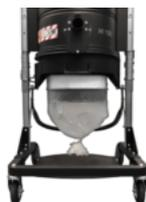
Il materiale viene raccolto all'interno di un robusto sacco di plastica chiamato Longopac® lungo 20 mt. Il sacco viene arrotolato al di sotto della camera ed è adattabile ad ogni esigenza. L'operatore, una volta riempitosi il sacco, può chiuderlo al di sopra del materiale aspirato caduto automaticamente al suo interno, sigillarlo, tagliare il segmento di sacco con i detriti e disfarsene in totale sicurezza, senza che vi sia contatto tra operatore e materiale.
