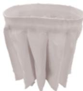
La filtrazione è garantita da un filtro in poliestere. La forma a stella permette il passaggio dell'aria anche quando il filtro è sporco. Il tessuto del filtro è in classe M (BIA | EN 60335-2-69). Questo significa che tutte le particelle fino a 1 micron vengono fermate dal filtro, in modo da proteggere i motori e l'operatore.
