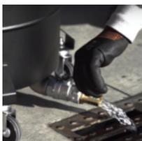
Lo scarico avviene grazie alla forza di gravità. Sulla parte inferiore della macchina è installata una valvola che permette di scaricare facilmente i liquidi e i detriti raccolti all'interno del contenitore.
