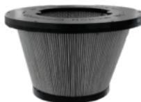
La filtrazione è garantita da un robusto filtro cartuccia in poliestere. La cartuccia è stata realizzata per mantenere un'ampia superficie filtrante (40.000 cm<sup>2</sup>) in uno spazio compatto. In questo modo l'aria può passare attraverso anche quando il filtro è sporco. Il filtro è certificato in classe M (BIA | EN 60335-2-69) e arresta le particelle fino a 1 micron, preservando i motori e l'operatore.
