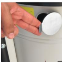
L'aspiratore è dotato di un nuovo sistema di pulizia filtro chiamato JetClean® progettato da Depureco. Grazie alla diversa pressione tra l'esterno e l'interno dell'aspiratore, il sistema genera un flusso d'aria che attraversando la cartuccia stacca la polvere dalla superficie del filtro. È un modo rapido ed efficace per mantenere pulito il filtro durante il lavoro, senza fermare l'aspirazione.
