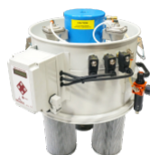
SP Pulizia cartucce in controcorrente d'aria Filtro antistatico classe M (EN 60335-2-69) 3 cartucce poliestere antistatico 9 m 2 superficie filtrante
