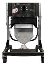
Le matériau est recueilli à l'intérieur d'un sac en plastique robuste appelé Longopac® qui mesure 20 mètres de long. Le sac est enroulé sous la chambre et peut être adapté à toutes les exigences. Une fois le sac rempli, l'opérateur peut le refermer sur la matière aspirée qui y tombe automatiquement, le sceller, couper le segment du sac contenant les débris et l'éliminer en toute sécurité, sans aucun contact entre l'opérateur et la matière.
