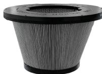
La filtration est assurée par un filtre à cartouche en polyester robuste. La cartouche est conçue pour maintenir une grande surface filtrante (35 000 cm<sup>2</sup>) dans un espace compact. Cela permet à l'air de passer même lorsque le filtre est sale. Le filtre est certifié classe M (BIA | EN 60335-2-69) et retient les particules jusqu'à 1 micron, préservant ainsi les moteurs et l'opérateur.
