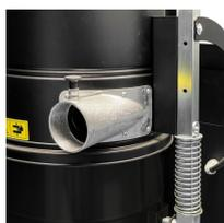
La entrada de aspiración es diseñada para recoger el material directamente dentro del contenedor desmontable. El ciclón es soldado dentro de la cámara, permitiendo de reducir la velocidad del material que entra dentro el aspirador. Con este sistema se alarga la vida de los filtros incrementando la seguridad para los operadores.
