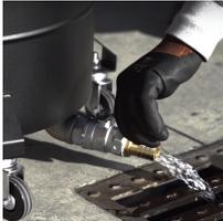
Die Entladung erfolgt durch die Schwerkraft. Im unteren Teil des Geräts befindet sich ein Ventil, mit dem die im Behälter gesammelten Flüssigkeiten und Ablagerungen leicht abgelassen werden können.
