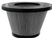
La filtración se asegura gracias a un filtro en cartucho robusto en poliéster. El cartucho es proyectado para llevar una grande superficie filtrante en un espacio compacto. De esta manera el aire puede atravesar el filtro aun si éste está sucio. El filtro esta certificado en clase M (BIA | EN 60335-2-69). Para las particulas hasta 1 micrón, preservando los motores y los operadores en los alrededores.
