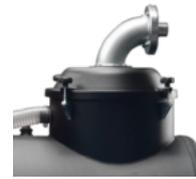
Das Material gelangt über die auf dem Deckel befindlichen Ansaugöffnung in den Spänekorb. Hier wird die Flüssigkeit von Feststoff getrennt und gefiltert.
