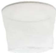
Die angesaugte Flüssigkeit wird im Sammelbehälter mit einem widerstandsfähigen Nylonfilter ausgestattet. Mit einer Abscheidewirkung von 150µ werden Feststoffe einbehalten und die Flüssigkeit durchgelassen. Dieser Filter ist auswaschbar und wiederverwendbar. Ebenfalls ist ein Nylonfilter mit einer Abscheidewirkung von 100µ erhältlich.
