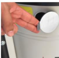
Der XM20JC ist mit dem Jetclean- Abreinigungssystem ausgestattet. Über eine manuell zu öffnende Klappe strömt während des Betriebs Luft in die Kammer des Saugers. Durch den entstehenden Sog verwirbelt die Luft im Gehäuse und reinigt das Filterelement ab. Ein optionaler manueller Absperrschieber verriegelt die Zuluft des Ansaugstutzens und erhöht die Effizienz der Abreinigung. Nach der Entriegelung des Absperrschiebers kann die Absaugung fortgeführt werden.
