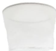
Die angesaugte Flüssigkeit wird im Sammelbehälter mit einem widerstandsfähigen Nylonfilter ausgestattet. Mit einer Abscheidewirkung von 150µ werden Feststoffe einbehalten und die Flüssigkeit durchgelassen. Dieser Filter ist auswaschbar und wiederverwendbar. Ebenfalls ist ein Nylonfilter mit einer Abscheidewirkung von 100µ erhältlich.
