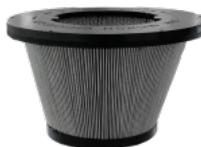
La filtrazione è garantita da un robusto filtro a cartuccia in poliestere. La cartuccia è stata realizzata per mantenere un'ampia superficie filtrante (35.000 cm<sup>2</sup> in uno spazio compatto). In questo modo l'aria può passare anche quando il filtro è sporco. Il filtro è certificato in classe M (BIA | EN 60335-2-69) e arresta le particelle fino a 1 micron, preservando i motori e l'operatore.
