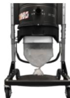
Il materiale viene raccolto all'interno di un robusto sacco di plastica chiamato Longopac® lungo 20 mt. Il sacco viene arrotolato al di sotto della camera ed è adattabile ad ogni esigenza. L'operatore, una volta riempitosi il sacco, può chiuderlo al di sopra del materiale aspirato caduto automaticamente al suo interno, sigillarlo, tagliare il segmento di sacco con i detriti e disfarsene in totale sicurezza, senza che vi sia contatto tra operatore e materiale.
