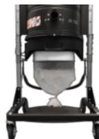
Das Material wird in einem robusten Kunststofftasche namens Longopac® gesammelt, der 20 Meter lang ist. Der Sack wird unter der Kammer aufgerollt und kann an jede Anforderung angepasst werden. Sobald der Sack gefüllt ist, kann der Bediener ihn über dem angesaugten Material, das automatisch hineingefallen ist, verschließen, das Segment des Sacks mit den Abfällen abschneiden und es sicher entsorgen, ohne dass es zu einem Kontakt zwischen Bediener und Material kommt.
