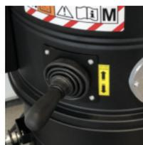
Filterabreinigung durch manuelles Rütteln über Rüttelstab.
