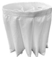
Die Filtration wird durch einen Polyesterfilter der Klasse M gewährleistet. Die Sternform ermöglicht eine Luftdurchströmung auch bei verschmutztem Filter. Das Filtergewebe entspricht der Klasse M (BIA | En 60335-2-69). Das bedeutet, dass alle Partikel bis zu einem Mikrometer durch den Filter gestoppt werden, um die Motoren und den Bediener zu schützen.
