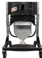
Das Material wird in einem robusten Kunststoffsack namens Longopac® gesammelt, der 20 Meter lang ist. Der Sack wird unterhalb der Kammer aufgerollt und kann an jeden Bedarf angepasst werden. Sobald der Sack gefüllt ist, kann der Bediener ihn über dem angesaugten Material, das automatisch hineingefallen ist, verschließen, das Segment des Sacks mit den Abfällen abschneiden und es sicher entsorgen, ohne dass es zu einem Kontakt zwischen Bediener und Material kommt.
