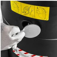
L'aspirateur est équipé d'un nouveau système de nettoyage du filtre appelé Jet Clean® conçu par Depureco. Grâce à la différence de pression entre l'extérieur et l'intérieur de l'aspirateur, le système génère un flux d'air qui traverse la cartouche et déloge la poussière de la surface du filtre. C'est un moyen rapide et efficace de maintenir le filtre propre pendant le travail, sans arrêter l'aspirateur.
