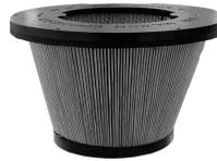
La filtration est assurée par un filtre à cartouche en polyester robuste. La cartouche est conçue pour maintenir une grande surface filtrante de 35 000 cm<sup>2</sup> dans un espace compact. Cela permet à l'air de passer même lorsque le filtre est sale. Le filtre est certifié classe M (BIA | EN 60335-2-69) et retient les particules jusqu'à 1 micron, préservant ainsi les moteurs et l'opérateur.
