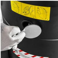
Der M65 JC ist mit dem Jetclean- Abreinigungssystem ausgestattet. Über eine manuell zu öffnende Klappe strömt während des Betriebs Luft in die Kammer des Saugers. Durch den entstehenden Sog verwirbelt die Luft im Gehäuse und reinigt das Filterelement ab. Ein optionaler manueller Absperrschieber verriegelt die Zuluft des Ansaugstutzens und erhöht die Effizienz der Abreinigung. Nach der Entriegelung des Absperrschiebers kann die Absaugung fortgeführt werden.
