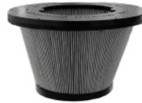
La filtración se realiza mediante un robusto filtro de cartucho de poliéster. El cartucho está diseñado para mantener una gran superficie filtrante (35.000 cm<sup>2</sup>) en un espacio compacto. Esto permite que el aire pase incluso cuando el filtro está sucio. El filtro tiene certificación de clase M (BIA | EN 60335-2-69) y detiene partículas de hasta 1 micra, preservando los motores y al operario.
