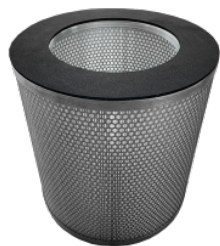
HEPA 14 Filtro assoluto (EN 1822) 110.000 cm 2 superficie filtrante Classe H14 (EN 1822) Fibra di vetro
