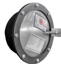
PANNELLO DI SFOGO DIREZIONALE Dispositivo di sfogo progettato per rompersi ad una determinata pressione e far sfogare la pressione esplosiva in un'area sicura Pannello direzionale esplosione
