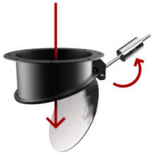
SCARICO A PALETTA CONTROBILANCIATA Il materiale viene scaricato in automatico ogni volta che viene fermata l'aspirazione.
