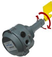
SENSORE DI LIVELLO ROTATIVO Sensore con paletta rotante che a contenitore pieno invia un segnale per interrompere immediatamente l'aspirazione
