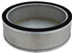
HEPA 14 Filtru absolut (EN 1822) 22.000 cm 2 filter surface H14 Class Filter (EN 1822) Glass fiber
