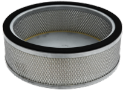
HEPA 14 Filtre absolu (EN 1822) 28.000 cm 2 surface filtrante Filtre antistatique classe H14 (EN 1822) Fibres de verre
