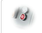
WARNLEUCHTE FÜR Filterverstopfung
