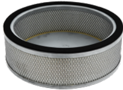
HEPA 14 Filtro absoluto (EN 1822) 22.000 cm 2 superficie filtrante Filtro antiestático clase H14 (EN 1822) Fibra de vidrio
