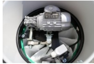
SE Halbautomatischer elektrischer Filterrüttler
