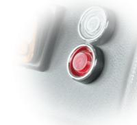
**WARNLEUCHTE FÜR FILTERVERSTOPFUNG**
