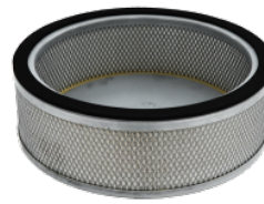
HEPA 14 Absolute filter (EN 1822) 22.000 cm 2 filter surface H14 Class Filter (EN 1822) Glass fiber
