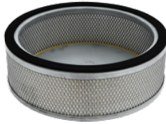
HEPA 14 Absolute filter (EN 1822) 22.000 cm 2 filter surface H14 Class Filter (EN 1822) Glass fiber
