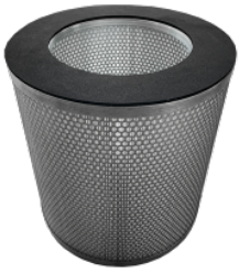
HEPA 14 Absolute filter (EN 1822) 110.000 cm 2 filter surface H14 Class Filter (EN 1822) Glass fiber
