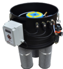
SP Décolmatage cartouches par injection air réseau air comprimé Filtre antistatique classe M (EN 60335-2-69), 3 cartouches polyester antistatique, 9 m 2 surface filtrante
