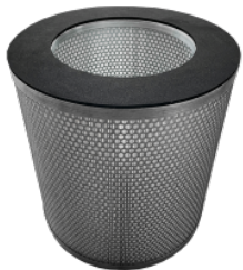
HEPA 14 Absolutfilter (EN 1822) 110.000 cm 2 Filterfläche Antistatischer H14 Klasse Filter (EN 1822) Glasfaser
