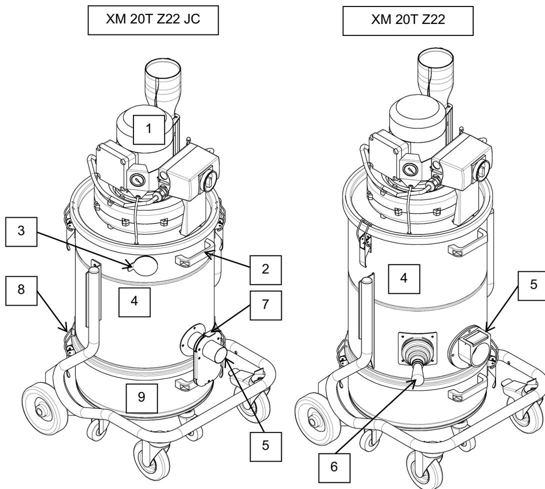
1. Cabeza del aspirador con mando de encendido/apagado
