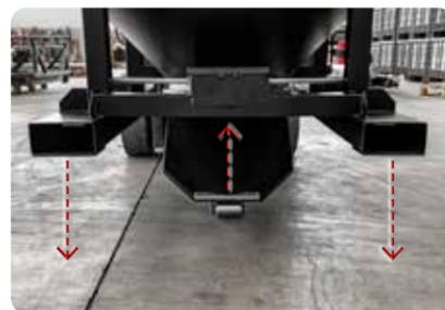
Système de fermeture de porte par pression au sol
