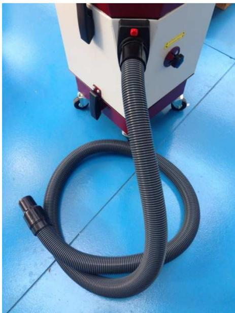
Connecter le côté opposé du tuyau de la connexion en Y d'extraction de la torche aspirante
