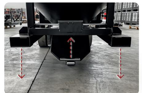
Sistema di chiusura portello a pressione sul pavimento
