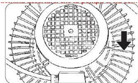
Se il senso di rotazione del motore non è corretto, è sufficiente inserire un cacciavite nell'apposito intaglio all'interno della spina di alimentazione ed invertire due poli con una rotazione di 180°.
