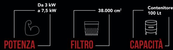
Aspiratore a turbina a canale laterale per applicazioni che richiedono più potenza. È dotato di un grande filtro standard in poliestere di classe M e di una valvola di sicurezza. Il materiale viene raccolto in un pratico contenitore smontabile da 100 L su ruote.
