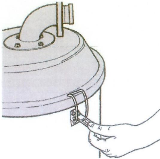
Se visono detriti all'interno del filtro oppure il filtro risulta forato è possibile sollevare tutto il gruppo filtrante mediante le apposite maniglie e procedere a parte all'estrazione del filtro e alla pulizia del portafiltro.
