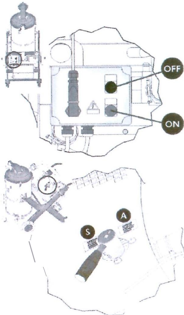
La leva di comando della valvola di aspirazione è collocata come in figura e può essere posizionata su ASPIRARE (A) oppure su SOFFIARE (S).
