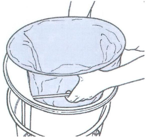
Sciagquare il portafiltro, inserire il nuovo filtro e rimontare il tutto all'interno del vano, rimontando e bloccando il coperchio.
