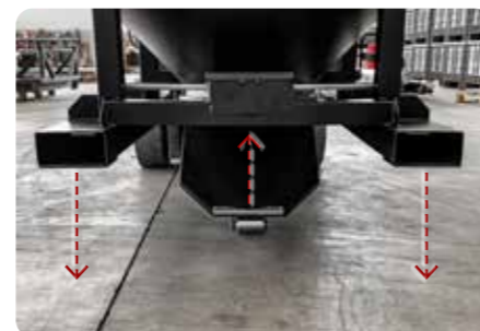
Sistem de închidere prin presare pe paviment.
