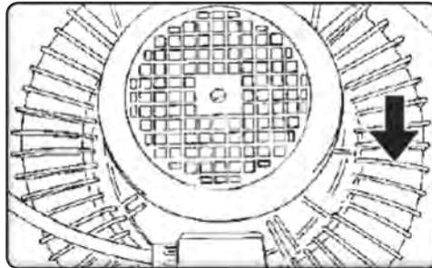
Andernfalls, um die Phasen der Stromversorgung zurückzusetzen, stellen Sie den Schalter (1) auf „0“, ziehen Sie den Stecker aus der Steckdose, stecken Sie einen Schraubendreher in den entsprechenden Schlitz im Inneren des Netzsteckers und vertauschen Sie die zwei Pole mit einer Drehung von 180°.
