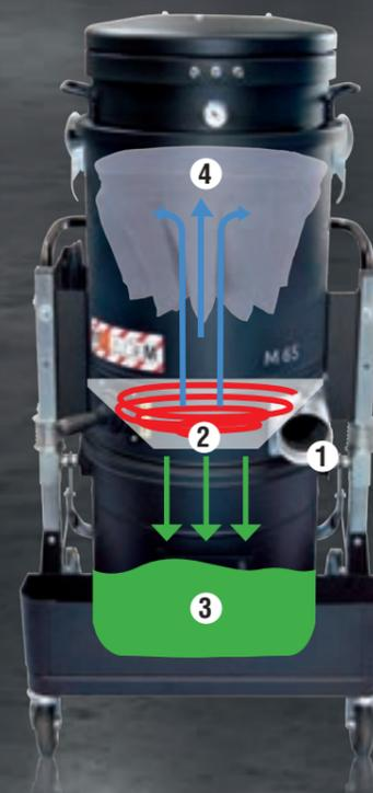
EL MATERIAL ASPIRADO ENTRA DE LA BOCA TANGENCIAL (1) Y GRACIAS AL CICLÓN (2) PIERDE DE VELOCIDAD, DECANTANDO DENTRO DEL CONTENEDOR DEL ASPIRADOR (3). DE ESTA MANERA SE ABATE HASTA EL 90% DE MATERIAL GARANTIZANDO LA DURABILIDAD DEL FILTRO (4).
