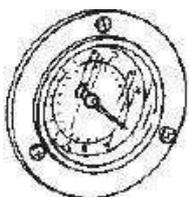
En el lado frontal del aspirador hay un indicador de vacío que indica el grado de depresión al interior del aspirador. El indicador de vacío indica al operador las condiciones de aumento de la depresión y el estado de atasco del filtro, con consiguiente reducción de la potencia de aspiración. Cuando el filtro se obstruye, el indicador de vacío indica el valor reportado en la tabla siguiente. En este caso, parar la máquina y limpiar el filtro
