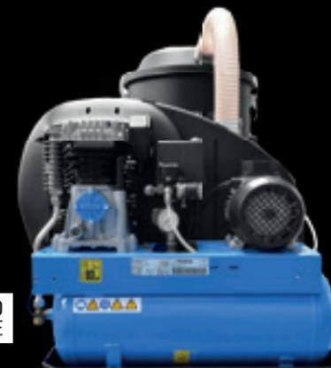
LE SYSTEME SP PERMET DE MAINTENIR LES FILTRES PROPRES AUTOMATIQUÉMENT SANS ARRÊTER L'ASPIRATION. CHAQUE FILTRE EST PÉRIODIQUÉMENT DÉCOLMATÉ PAR UN JET D'AIR HAUTE DÉBIT (6 BAR)
