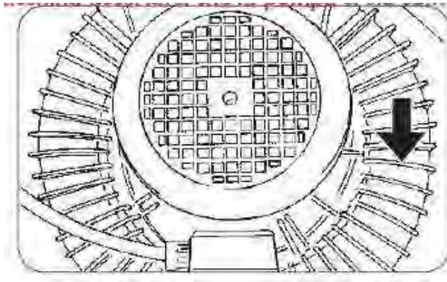
Si le sens de rotation du moteur n'est pas correct, il suffit d'insérer un tournevis dans l'entaille spécifique à l'intérieur de la fiche d'alimentation et d'inverser les deux pôles en tournant de 180°.
