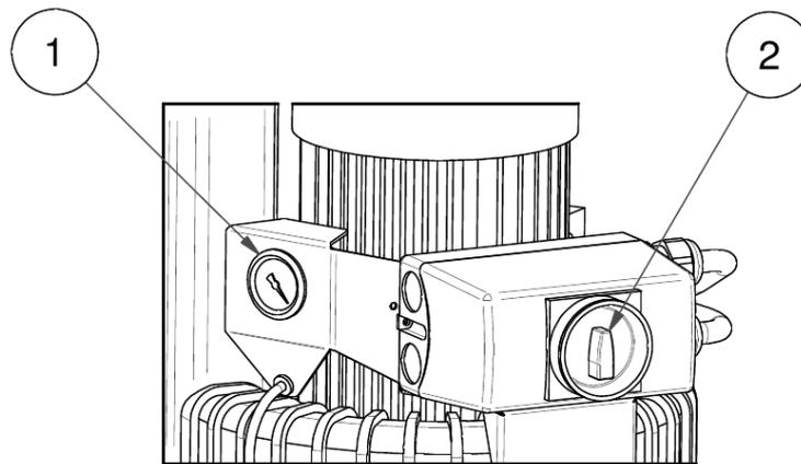
1. Vacuomètre : signale que le filtre d'aspiration est colmaté
