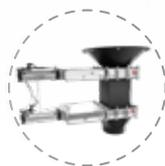
doppelte elektropneumatische Guillotineklappe zur Entladung
