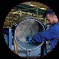
kipbarer Trichter zur Entleerung der Spaene
