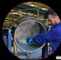
kippbarer Trichter zur Entleerung der Späne
